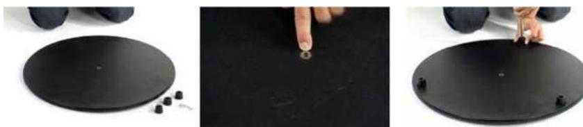
**ШАГ 5:** сначала подножки должны быть присоединены к базовой плите. Выберите базовую плиту с (1) центральным отверстием и (3) отверстиями вдоль краев. **ВАЖНО:** подножки должны быть прикреплены к стороне с центральным отверстием из желтой меди. Завинтите крепко все (3) подножки более широкой стороной, обращенной к плите, используя (3) средних серебряных крестообразных винта.
