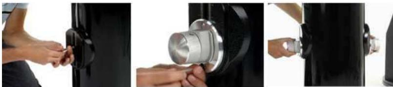
**ШАГ 1:** удалите (2) болта, расположенные на отверстиях на одной стороне ОТА (блока оптической трубы). Здесь вы будете присоединять серебряные боковые подшипники. Выровняйте подшипник (сначала верхний болт) и закрепите его. Повторите на другой стороне ОТА.
