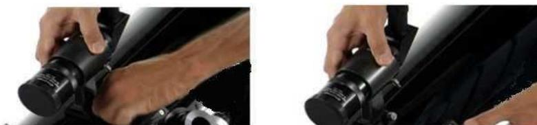
**ШАГ 3:** поместите кронштейн видоискателя на ОТА. Ослабьте винт с накатанной головкой на кронштейне вашими пальцами и задвиньте видоискатель до отказа. Затяните винт таким образом, чтобы видоискатель был хорошо закреплен.
