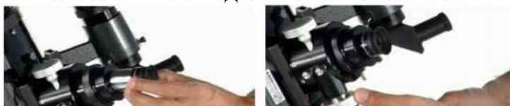
1. 1.25-дюймовый является наиболее широко применяемым форматом окуляра. Размер 1.25 дюймов – это диаметр окулярной трубки, измеренной по хромированной стороне.
