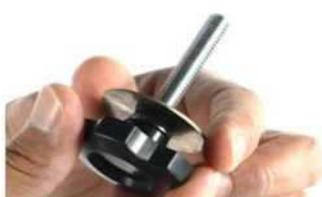
**ШАГ 8:** чтобы смонтировать регулировочный болт, держите детали в вашей руке в следующем порядке: маленькая шайба; шариковый подшипник; большая шайба. Поместите их на болт с резьбой в указанном порядке, маленькая шайба должна быть возле пластиковой головки.
