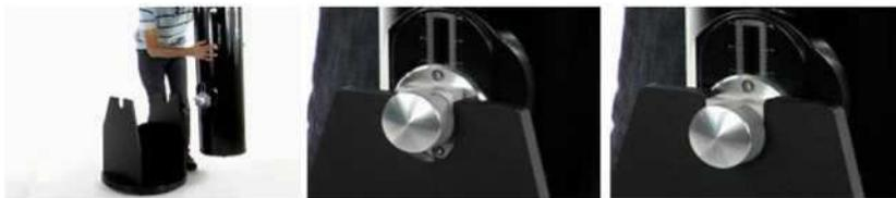
**ШАГ 2:** теперь в готовы поместить ОТА на узел базы. Узел базы должен быть готов для выравнивания с ОТА перед тем, как вы поднимите оптическую трубу. Углубления на узле базы будут идеально совпадать с серебряными боковыми подшипниками на ОТА.
