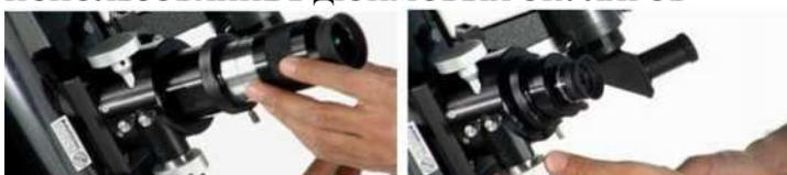
1. 2-дюймовый формат окуляра является самым крупным. 2 дюйма – это диаметр окулярной трубки, измеренной по хромированной части корпуса окуляра.
