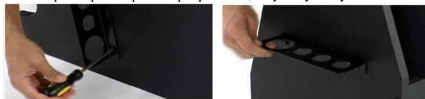
**ШАГ 4:** чтобы прикрепить лоток для окуляров к правой базовой стороне, легче всего повернуть сборочную единицу на бок. Прикрепите лоток, используя (2) предварительно просверленных отверстия и (2) черных крестообразных винта. Верните базу в вертикальное положение и убедитесь, что лоток закреплён.
