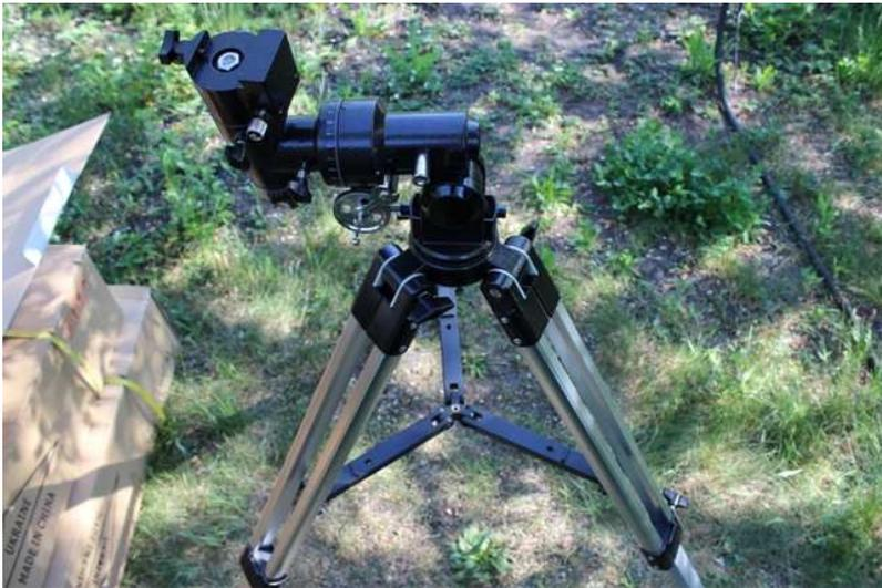
Монтировка телескопа экваториальная. Она оснащена одним противовесом и площадкой для крепления труб типа «ласточкин хвост». Возможна автоматизация слежения за небесными объектами путем установки двигателя на экваториальную ось телескопа.
